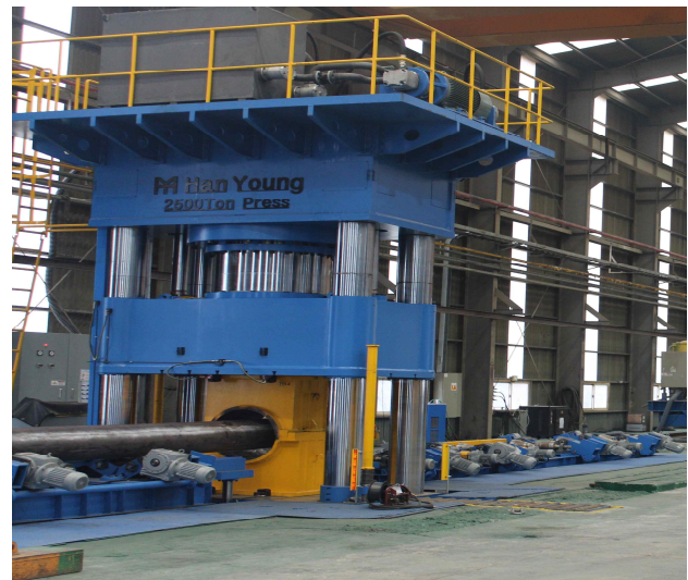
2,500TON 프레스 군산조선해양기술사업협동조합 납품 (파이프 제작 생산기계)
