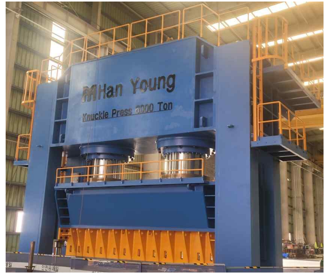
군산조선해양기술사업협동조합 납품 (JCO공법 파이프 생산 PRESS 6,000TON × 6M)
