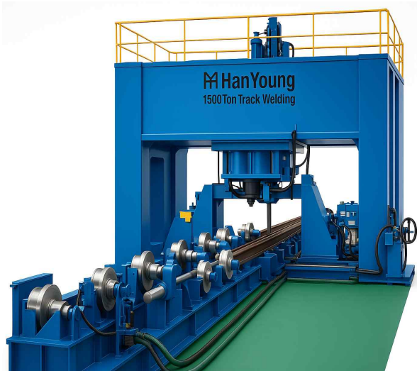
구만중공업 납품 (파이프제작 Tack Welding 기계)
