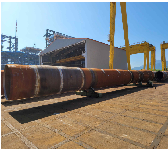
후육관 파이프 제작 완료 (후육관 파이프생산품 모노파일 야적장)
