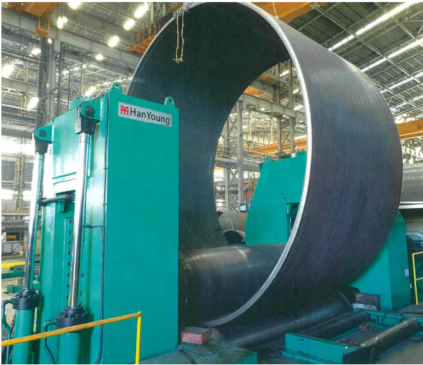
(주)SK오션플랜트 납품 (풍력발전용 하부구조물 모노파일 생산기계)
